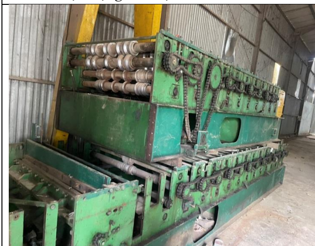
3. Hiện trạng máy cán tole
