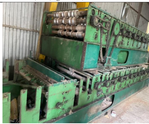
4. Hiện trạng máy cán tole
